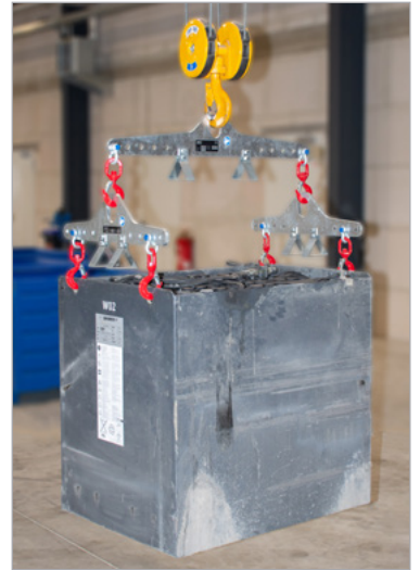
Kombination aus mehreren Traversen zur H-Traverse
