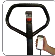
Die Kippfunktion wird durch die Kabelfernbedienung gesteuert.
