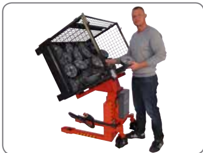
Die Deichsel kann gedreht werden, so dass der Anwender freien Zugang zum Inhalt der Gitterbox oder Behälter hat.
